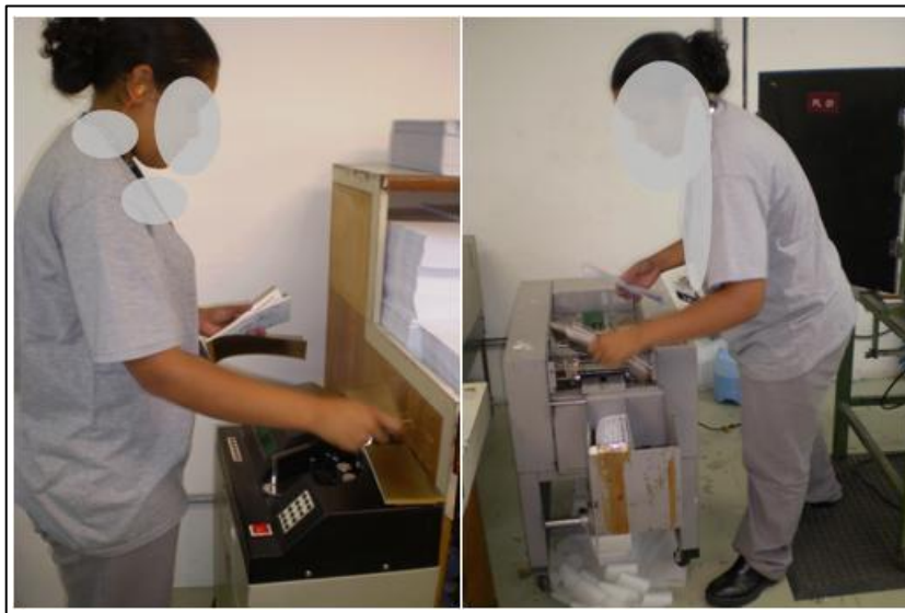
Figura 20 – Sequencia de movimentos nas etapas de contagem das folhas e aplicação de lombada Fonte: Arquivo Pessoal, 2011
