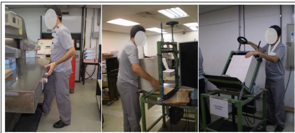
Figura 17 – Sequencia de movimentos nas etapas de corte na guilhotina e colagem dos impressos Fonte: Arquivo Pessoal, 2011
